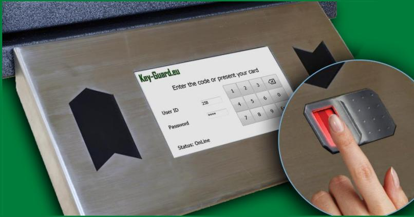
Супер яркий, большой, сенсорный TFT дисплей позволяет не только легко и просто управлять системой хранения ключей, но так же быстро получить любую интересующую Вас информацию. К примеру, кто и когда взял ключ или в какой ключнице на объекте находится данный ключ. Система позволяет осуществить поиск ключа по номеру или по названию, выдавать ключи списком.
